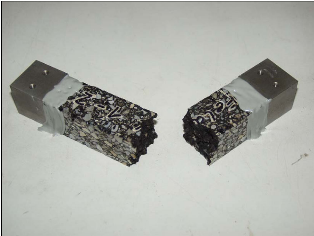
Abbildung A 5: Probekörper nach dem Abkühlversuch
