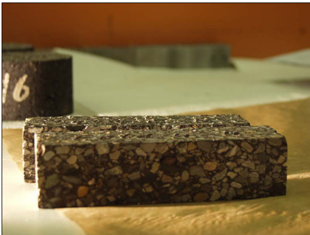
Abbildung A 1: Probekörper vor und nach der Wasserlagerung
