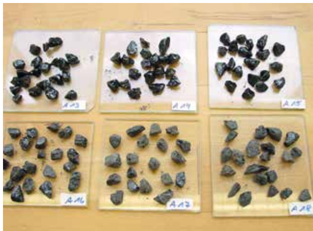
Bild 2: Vergleich der Affinität von Bitumen und Gesteinskörnung bei Zugabe von Kalkhydrat (A 13 bis A 15) und ohne Zugabe von Kalkhydrat (A 16 bis A 18) nach Rolling bottle test (DIN EN 12697-11; TP Gestein-StB, Teil 3.4)
