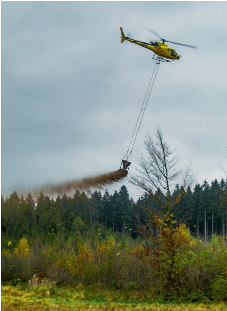
Abb. 8: Ausbringung von angefeuchtetem Kalk per Helikopter.
