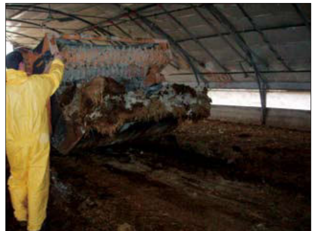
Abb. 1 Beispiel einer Homogenisierung von Mist und Kalk mithilfe von Standard-Mischgeräten (Ain – Frankreich) innerhalb des Stalls
