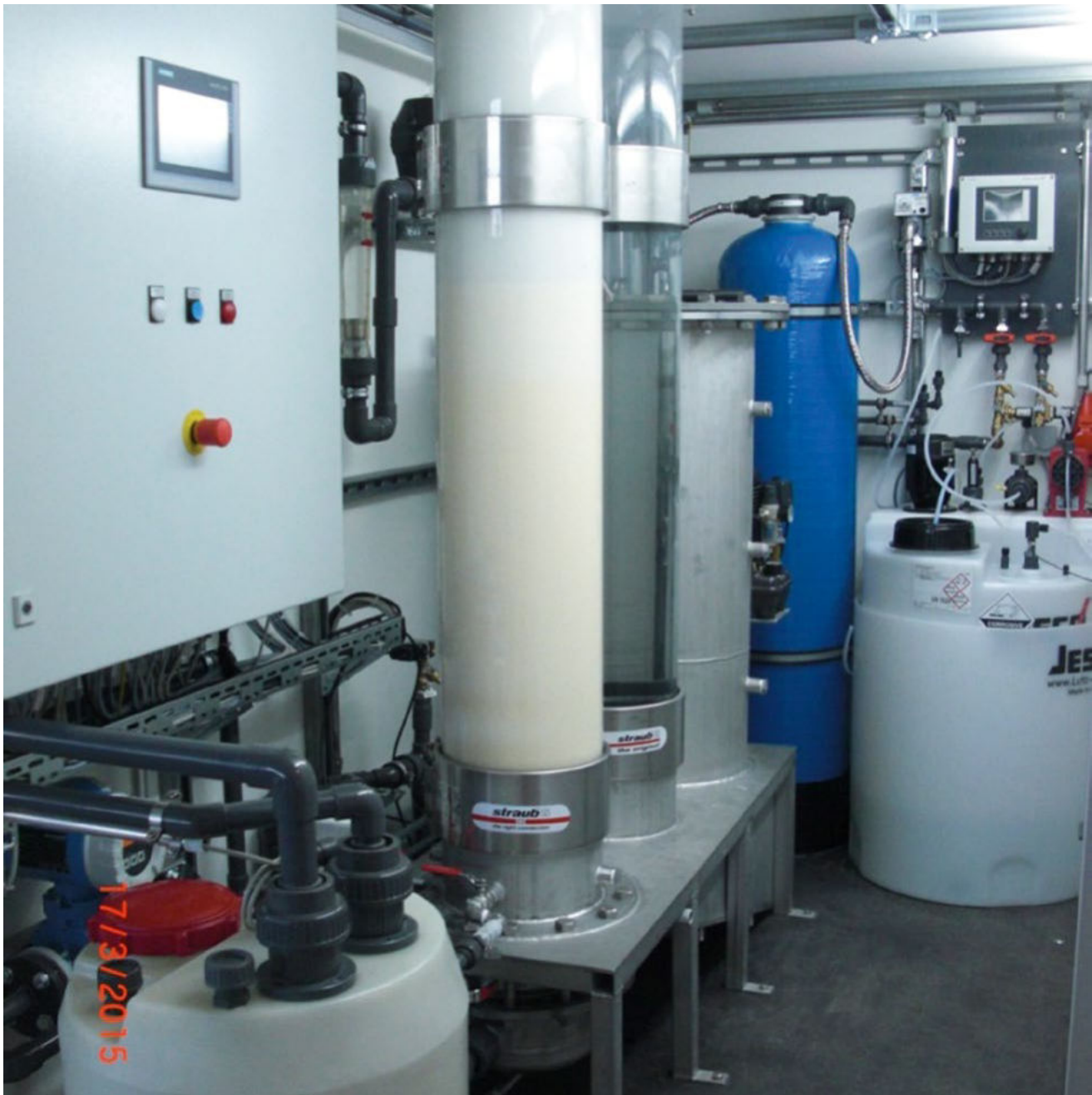
Abbildung 7: Mobiler Versuchswirbelbettreaktor der Firma ALWIN EPPLER GmbH & Co. KG
