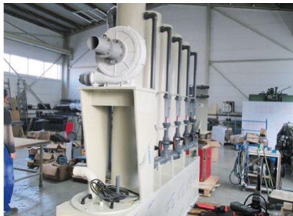
Abbildung 1: Fotos der mobilen Demonstrationsanlage, 5-stufiger CO 2 -Wäscher
