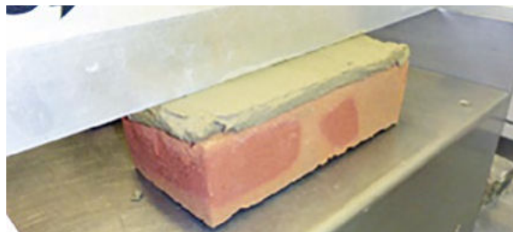
Mörtelauftrag definierter Dicke Ziegel
