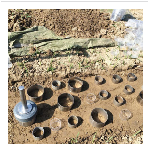
Abbildung 3: Stechzylinder zur Entnahme von ungestörten Bodenproben
