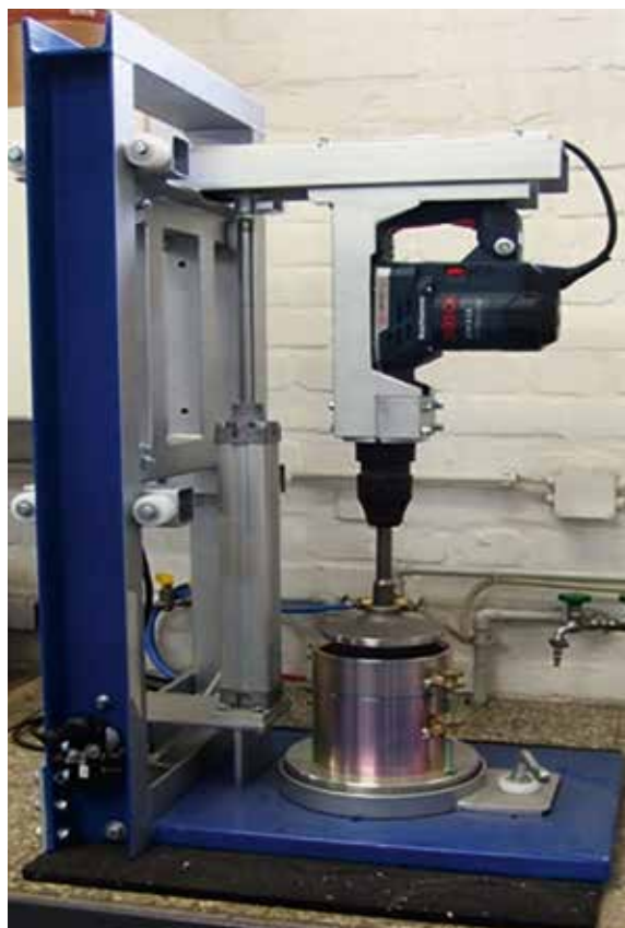
Abb. 1: Vibrationshammer, gebaut vom FEhS (Institut für Baustoffforschung e. V.)
