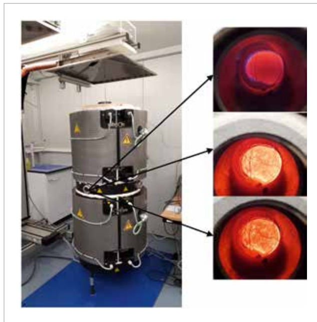
Abb. 7: Der neue Rohrofen und Fotoaufnahmen vom Kokspartikel während des Versuches
