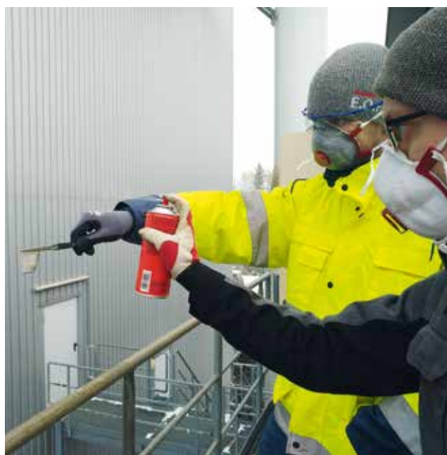
Abb. 4: Konservierung der Proben mit Zaponlack für eine spätere Analyse im Labor
