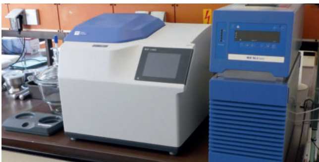
Kalorimeter (PCS-Apparatur) zur Bestimmung der Bruttoverbrennungswärme
